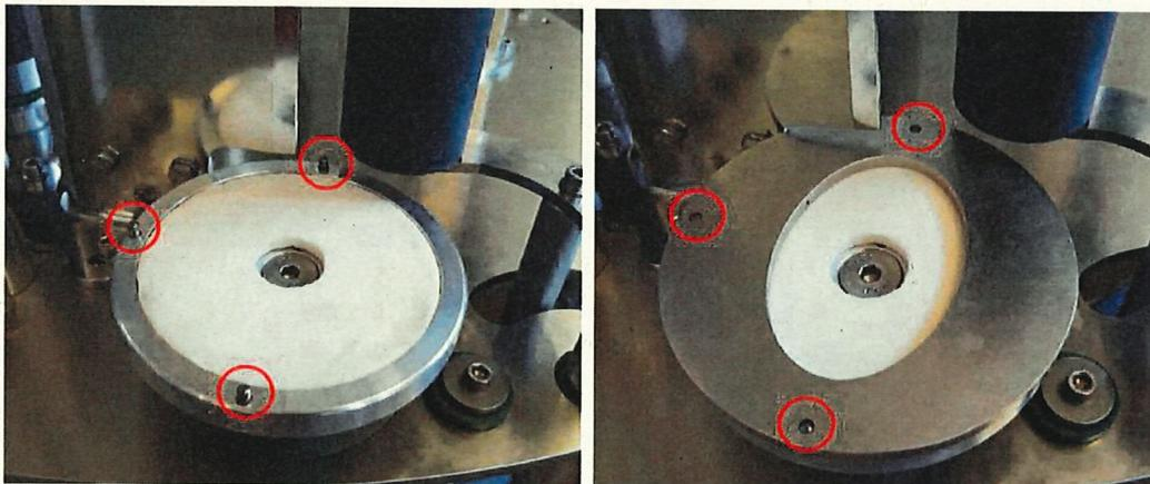
Zum Entfernen einer Schablone vom Drehtellersockel wird sie einfach mit einem leichten Druck nach oben abgezogen.
