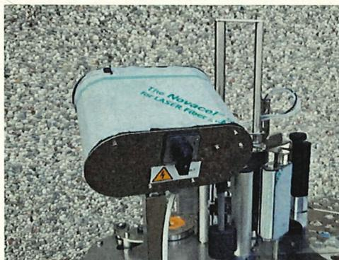
Die Maschine ist mit einer doppelten Druckknopftafel zur Aktivierung des Etikettierzyklus ausgestattet: Die zwei Tasten müssen gleichzeitig gedrückt werden, um den Arbeitszyklus zu starten.
