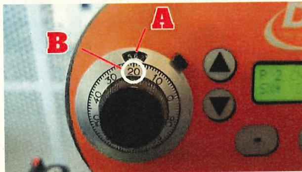
Zum Einstellen des Behälterdurchmessers ist das Potentiometer auf der linken Seite der Steuertafel zu verwenden. Die Zahl A im schwarzen Kästchen gibt die Zentimeter an, während die Zahl B auf der Metallringmutter die Zehntelmillimeter angibt. Zum Beispiel ist auf der Abbildung der eingestellte Wert 6,2 cm bzw. 62 mm.
