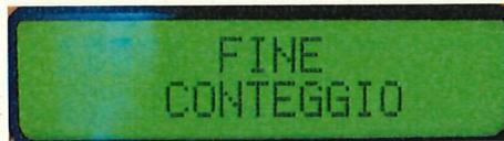
**ZUR BEACHTUNG:** Nach jedem abgeschlossenen Etikettiervorgang wird das Zählwerk PZ um eins zurückgesetzt. Bei Erreichen von Null hält die Maschine an und der Bildschirm ZÄHLUNGSENDE wird angezeigt. Zum Fortsetzen des Etikettiervorgangs ist auf den Arbeitsbildschirm zurückzukehren, indem die Taste <SEL> gedrückt wird, um dann ist ein neuer positiver Stückzahlwert PZ einzugeben.
