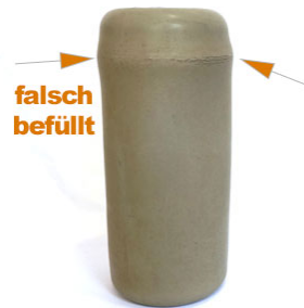
Schäden durch falsche Befüllung
