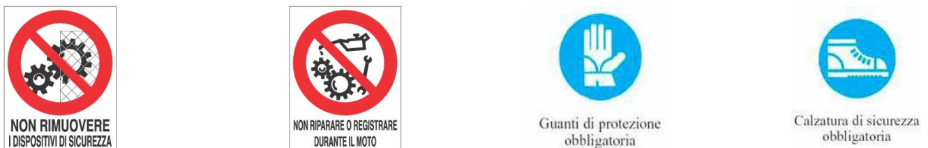
Figura n.7 Indicazioni di pericolo e precauzioni
