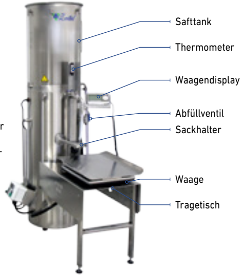
Abbildung 2: Bestandteile des PE200 Abfülltisches (für Bag-In-Box)
