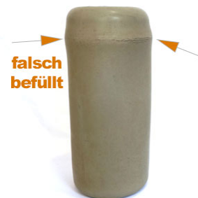
Schäden durch falsche Befüllung
